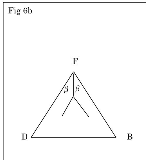
図 6a で  $AB = AC = AD = kL$   $BC = CD = DB = L$  とする。辺 AC に点 D から下した垂線の足を F とする。図 6b で側面の板材①どうしのなす角を図のように定め、 $\tan \beta$  を求める。三角形 ABC の面積について次の式が成り立つ。
