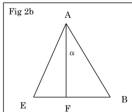
$A$  から辺  $BE$  に垂線を下し、その足を  $F$  とする。直線  $AF$  は3角形  $BCD$  の回転に関する対称軸であり、点  $F$  は3角形  $BCD$  の外心であるが、3角形  $BCD$  は正3角形なので、点  $F$  は3角形  $BCD$  の重心にもなっている。そのため計算は楽である。 $\angle BAF = \alpha$  とする。以後この角度を垂直接合角 (Vertical Joint Angle)と呼ぶことにする。
