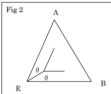
今度は板で作るので、角材よりもはるかに簡単である。同じ大きさの正三角形の板の縁を角  $AEB$  の半分角度  $\theta$  ですべて斜めに切り落とすか削るかする。以後、この角度  $\theta$  を 面接合角(Plate Joint Angle) と呼ぶ。
