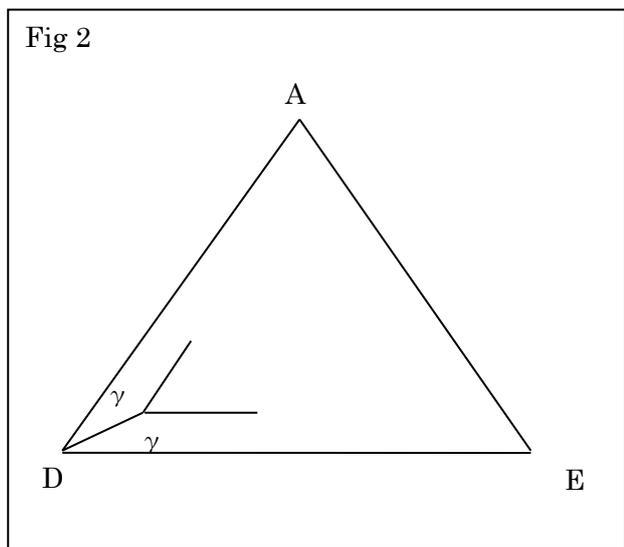
$\angle ADE = 2\gamma$  として  $\frac{1}{\tan \gamma}$  を求める。これが底面とそれに繋がる正三角形の縁の切り込みを決める。
