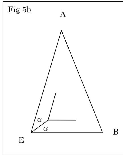
図 5a で  $AB = AC = AD = kL$   $BC = CD = DB = L$  とする。辺 CD の中点を E とする。側面の板材①と底面の板材②のなす角を図 5b のように定め、 $\tan \alpha$  を求める。面接合角は  $\alpha$  と  $\beta$  の 2 種類ある。
