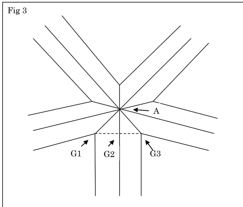
$$\angle G1AG3 = 72^\circ = \frac{2\pi}{5} \quad AB \perp G1G3 \quad \text{であるので水平接合角} \quad \angle G1AG2 = \frac{\pi}{5}$$
