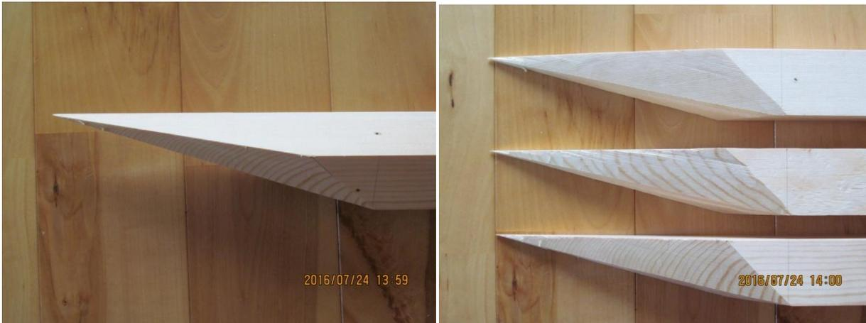
この 3 本をどのようにしてまとめるかであるが、 $M$  が小さいものなら、数 cm から 10cm 程度のねじ 3 本でよい。作ってしまえばそのまましておくし、簡単に分解もできる。しかし、 $k=2$   $L=2.5m$   $M=105mm$  ともなると 1 本の部材が長さ 5m、重量は 25kg から 30kg にもなり、不用心に作ると危険である。また、作成、分解の手間も考えなくてはならない。今回はこの 3 本の部材を 3 枚の金属プレートで止めることにした。その金属プレートは flat(たいら)ではなく、ある程度の角度で曲げておかなくてはならない。その角度を計算する。角材で正 4 面体を作るときの微妙なふくらみの角度である。
