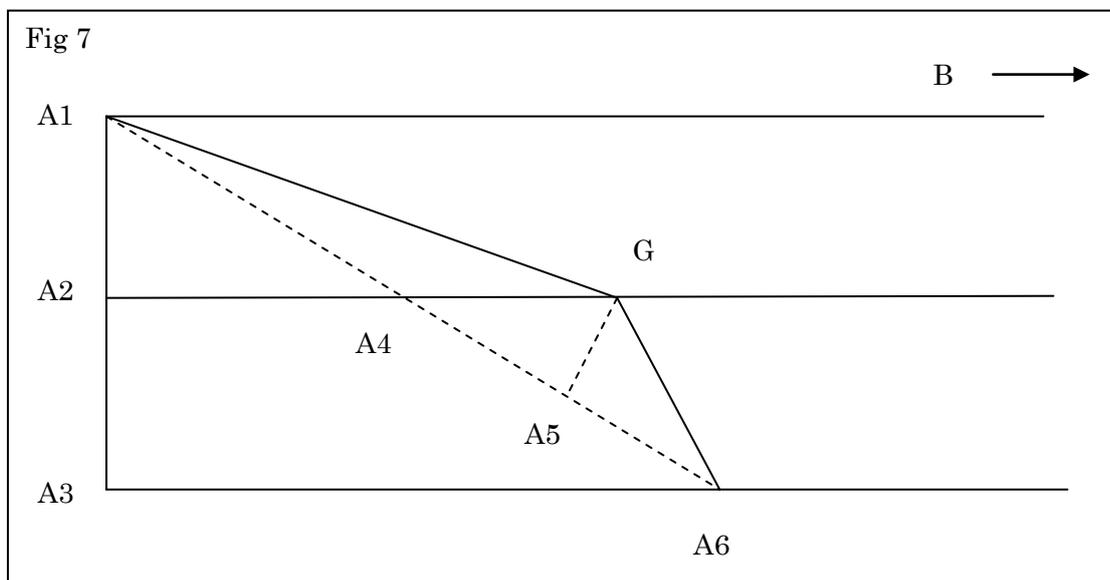
点 A における水平接合角  $\theta$  と接合深さ  $t$  は正 4 面体と同一で  $\theta = 60^\circ$   $t = \frac{M}{\sqrt{2} \tan \theta} = \frac{M}{\sqrt{6}}$
