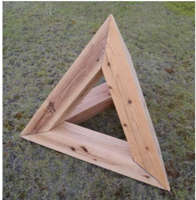
正 6 面体、正 8 面体、正 12 面体、正 20 面体も殆ど同様にして、角材の墨付けの寸法が求められる。
